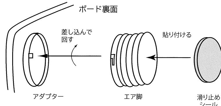
エア脚の突起をボード裏側にある「取り付け部」に合わせ取り付けしてください。
