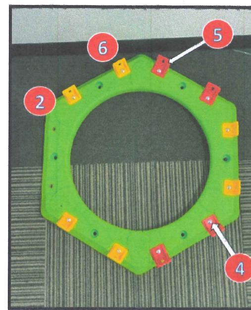
2 の六角型番を用意し、6 の短いバックルと 5 の大きいバックルを左図のように、交互に使用し 4 の短いネジを用いて仮止めを行います。
