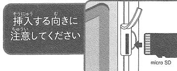
図のような向きでmicro SDカードを、カチッと音がするまで押し込んで装着してください。再度micro SDカードをカチッと音がするまで押し込むと、取り外すことができます。
