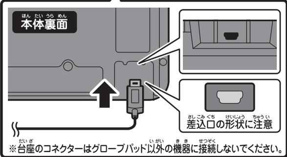
コネクターを台座のくぼみに収納し、グローブパッドがガタつかないようにセットします。
