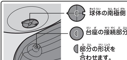
球体の南極側にある黒いパーツと、台座の接続部分の形状が合うように球体を取り付けます。
