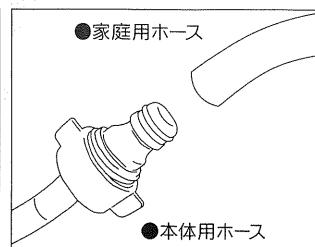
図のように本体用ホースを取付けます。途中にマジックテープがいくつありますので必ず全てのマジックテープを留めてください。ホースに足を引っ掛けてしまい、破損、怪我の恐れがあります。
