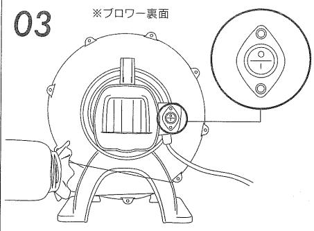
電源プラグをコンセントの差込口に挿し、プロワーのスイッチをONにします。
