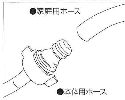
図のように本体用ホースを取付けます。途中にマジックテープがいくつありますので必ず全てのマジックテープを留めてください。ホースに足を引っ掛けてしまい、破損、怪我の恐れがあります。
