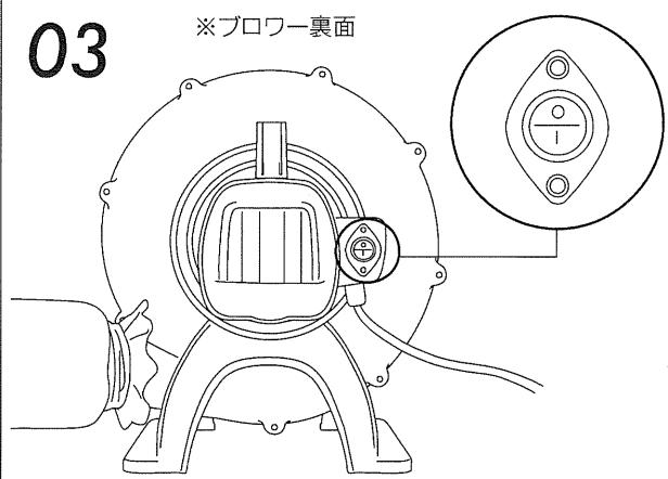
電源プラグをコンセントの差込口に挿し、プロワーのスイッチをONにします。
