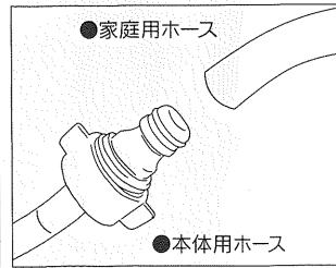
図のように本体用ホースを取付けます。本体にマジックテープがいくつかついておりますので必ず全てのマジックテープを留めてください。ホースに足を引っ掛けてしまい、破損、怪我の恐れがあります。
