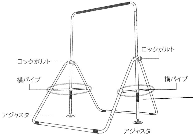
※固定用ネジはそれぞれのパイプに仮止めしていますので、一旦ネジを外してから取り付け、しっかりとネジ止めしてください。
