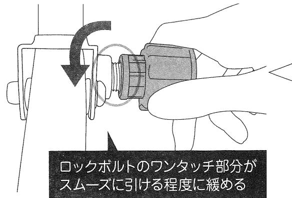
※ロックボルトを引くと、高さ調整パイプのロックが外れます。
