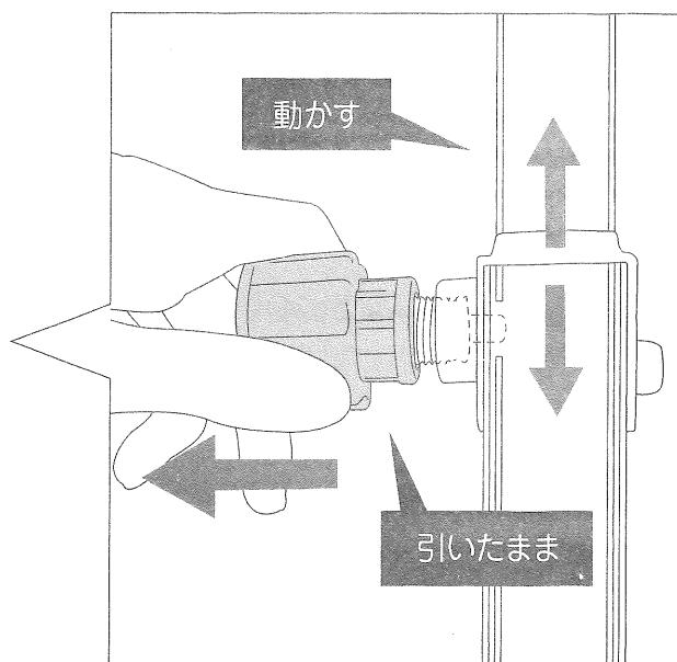
⚠ 高さを調整する際は、鉄棒パイプの中央部分を持ち上げて調整してください。
